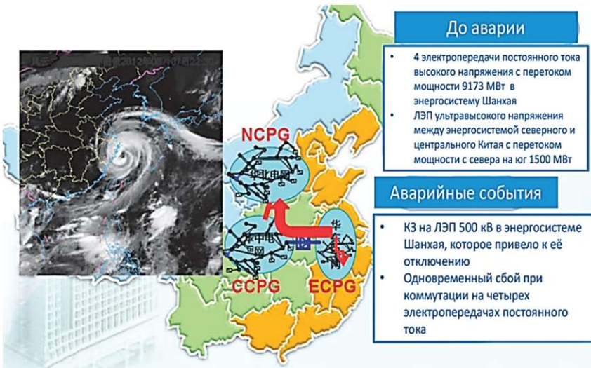
Рис. 2.17. Последствия тайфуна Хайкуй для ЭЭС Китая (Источник. CEPRI. CIGRE. 2014)
