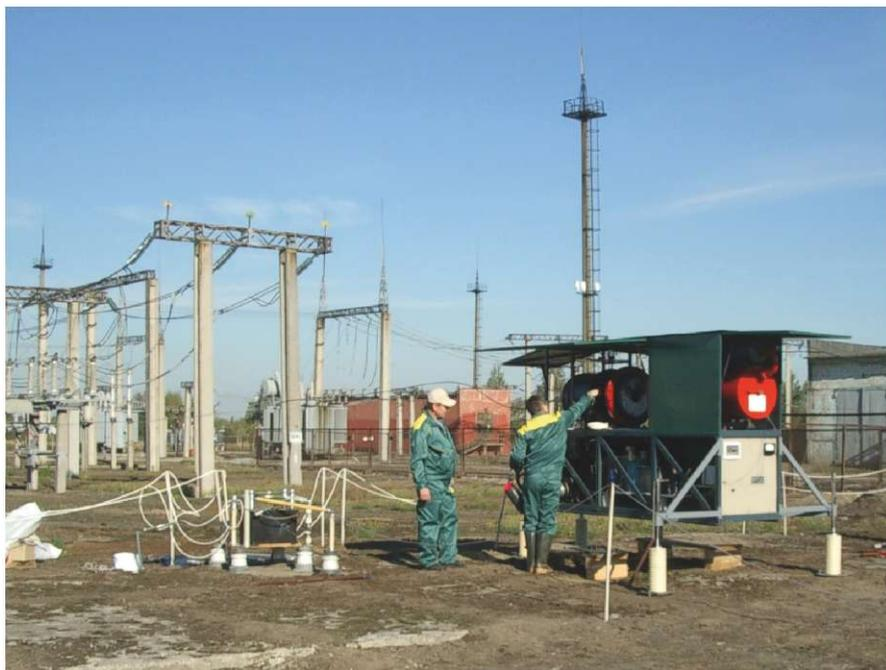
Рис. 9.86. Эксперименты по имитации удара молнии в молниеотвод с помощью взрывомагнитного генератора
