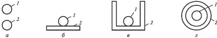
**Рис. 10.6. Различные виды расположения параллельного заземляющего провода 1 и основного заземляющего провода 2 в порядке увеличения эффективности действия:**
