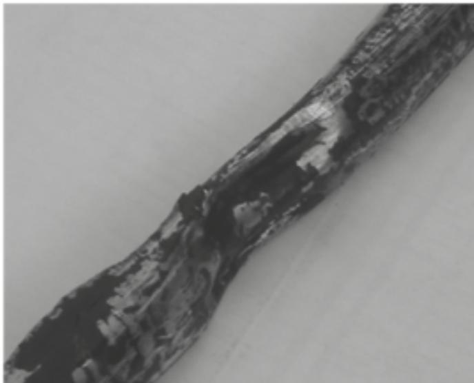
Рис. 9.77. Перекрытие на кабель с заземляющего устройства молниеотвода
