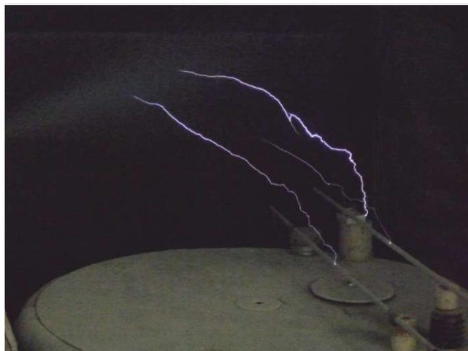
Рис. 9.30. Поражение моделей тросового молниеотвода и фазного провода разрядами из искусственной грозовой ячейки отрицательной полярности
