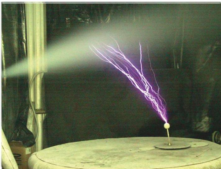
**Рис. 9.25. Искусственное облако заряженного водного аэрозоля и электрические искровые разряды, инициированные с заземленного электрода**
