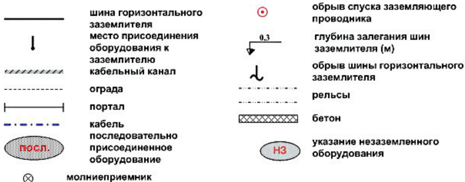
Рис. 1.2. Пример исполнительной схемы заземляющего устройства подстанции 35/10 кВ
