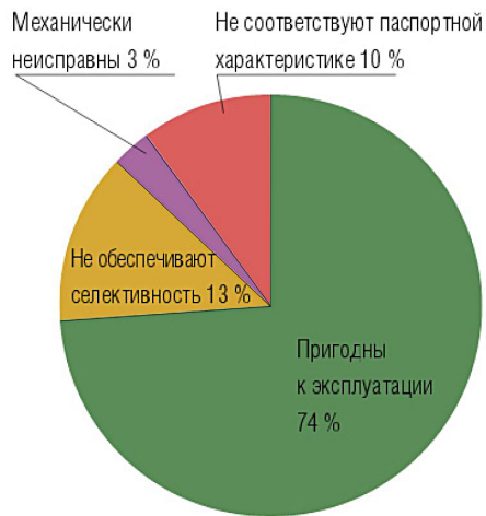
Рис. 4.63. Состояние АВ по результатам проверки (выборка 4 376 шт.)
