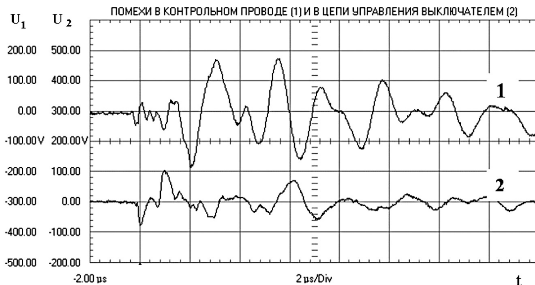
Рис. 3.9. Импульсные помехи при коммутации разъединителем в контрольном проводе (1) и цепях управления выключателем (2)
