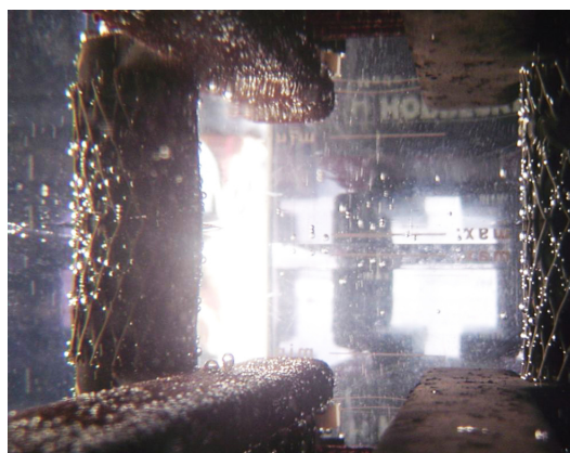
Рис. 4.54. Обильное газовыделение внутри элемента новой АБ из-за нарушения режима первой зарядки
