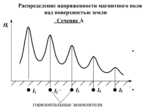
Рис. 1.1. Определение трассы прокладки заземлителей
