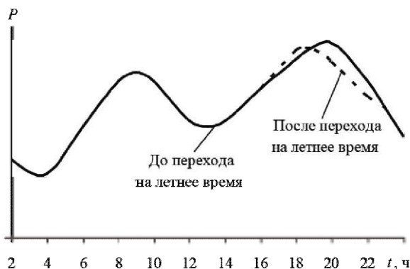
Рис. 2.3. Суточные графики нагрузки до и после перехода на летнее время (перевод стрелок часов на час вперед)
