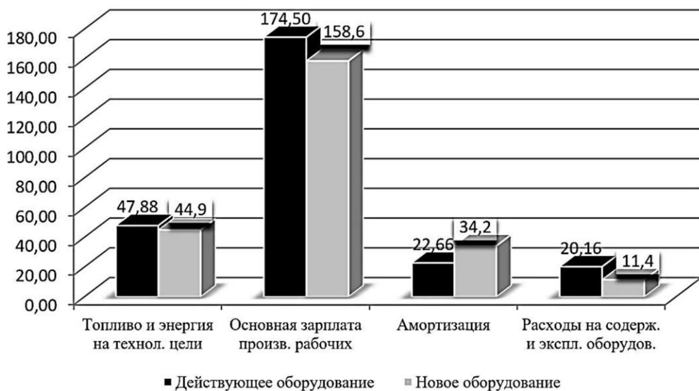
Рис. 2.5. Изменение основных статей затрат на производство 1 м 2 продукции при модернизации производственного оборудования
