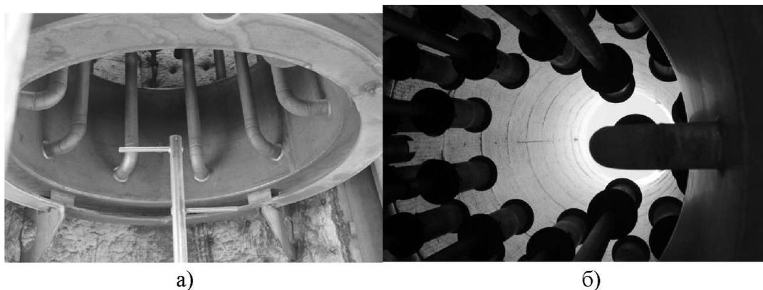
**Рис. 2.6. Внутрикорпусные устройства факельной установки производительностью 2,5 тыс. м<sup>3</sup> в час:**
