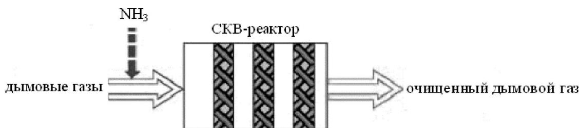
**Рис. 5.11. Принцип работы селективного каталитического восстановления оксидов азота**
