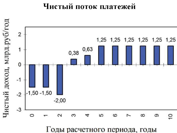
Рис. 8.3.2. Графический метод определения срока окупаемости
