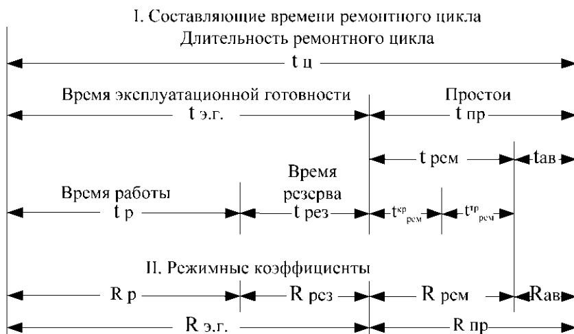
Рис. 10.3.1. Составляющие времени ремонтного цикла t_{\text{ц}} и режимные коэффициенты R_i
