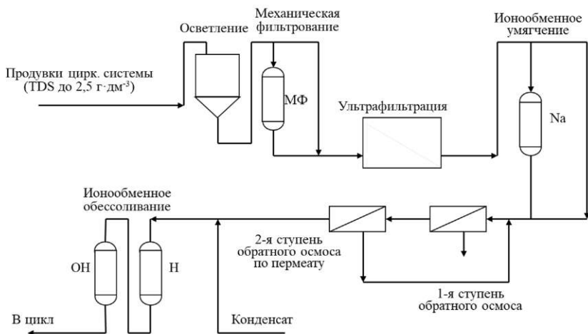
Рис. 9.19. Принципиальная технологическая схема ВПУ на Ростовской ТЭЦ-2:
