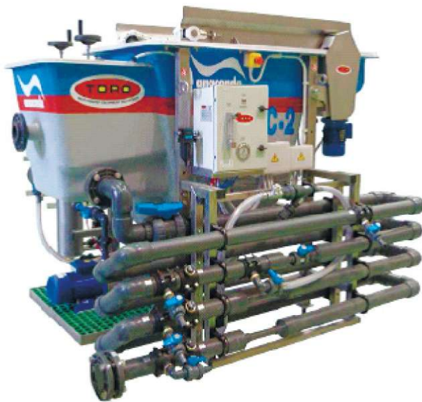
Рис. 2.16. Напорная флотация с растворенным воздухом: а) принцип действия DAF; б) внешний вид микропузырьков; в) схема конструкции флотатора DAF коридорного типа; г) пример внешнего вида пилотной установки с флотатором типа DAF
