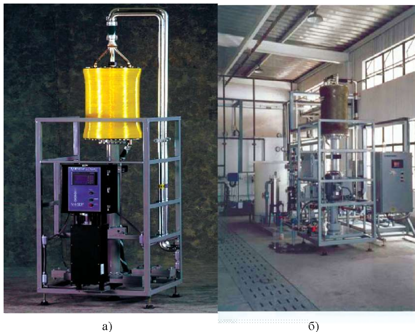
Рис. 5.48. Мембранный модуль ВМР с приводом на раме (а) и установка ВМР (б)
