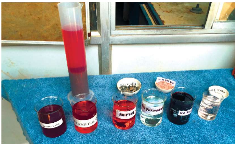
Рис. 8.12. Пробы входной воды, пермеата и концентрата с установки, работающей по схеме рис. 8.11
