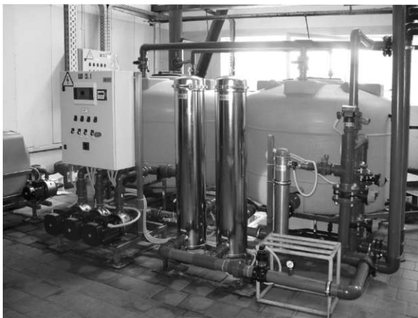
Рис. 5.40. Внешний вид блока химической мойки для промышленных установок серии ДВС-М/150-8-54
