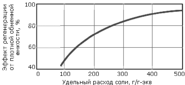
Рис. 4.13. Влияние расхода соли на эффект регенерации катионита
