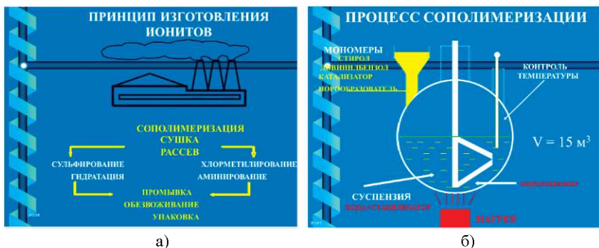
Рис. 4.1. Технология производства ионитов методом сополимеризации:
