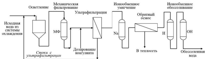
Рис. 9.17. Принципиальная технологическая схема ВПУ на ТЭЦ-21 Мосэнерго:
