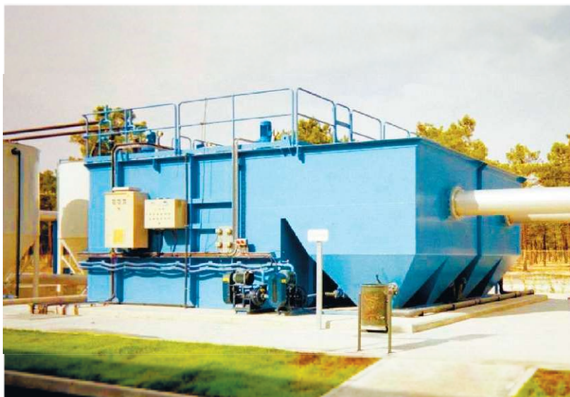
Рис. 2.13. Осветитель типа Actiflo:
