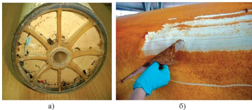
Рис. 5.41. Загрязненные рулонные мембранные элементы: а) внешний вид, б) после вскрытия (аутопсии)
