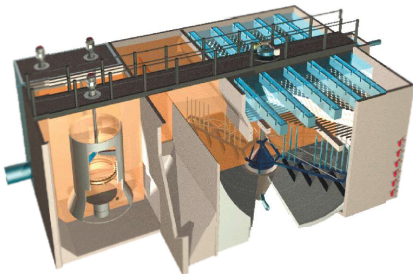
Рис. 2.14. Внешний вид и разрезы осветлителя типа Densadeg: а – схема; б – внешний вид и разрезы
