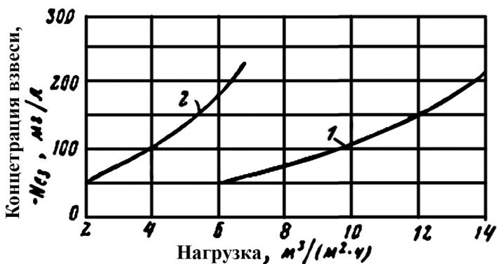
Рис. 3.12. Зависимость концентрации взвеси в осветленной воде от нагрузки гидроциклона:
