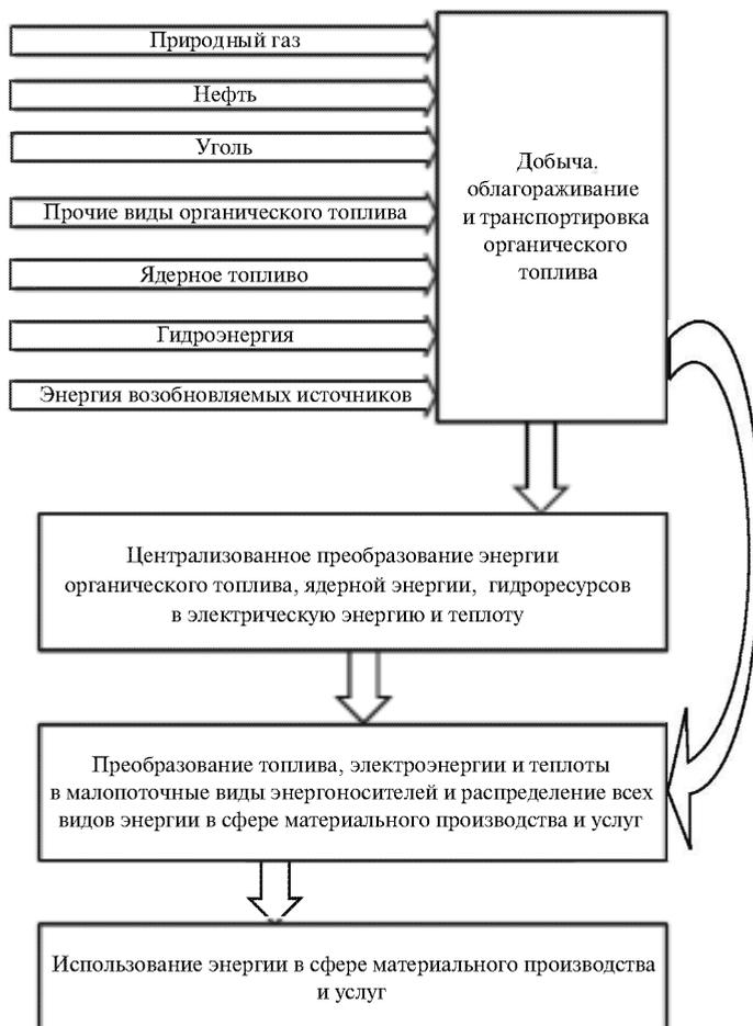
Рис. 2.6. Структурная схема функционирования энергетики России
