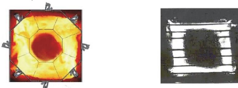
**Рис. 20.34. Аэродинамика факела в тангенциальной топке**
