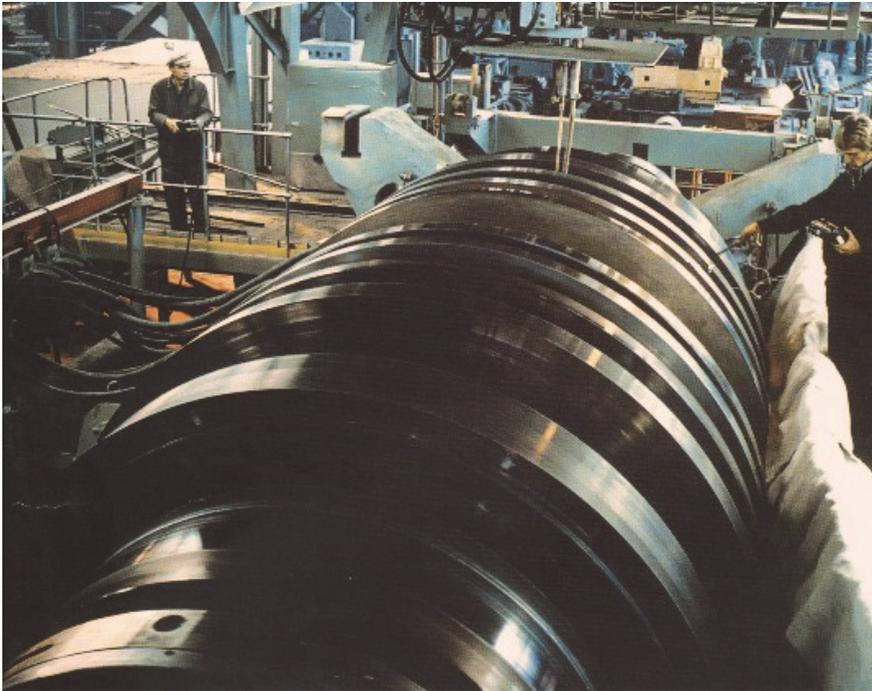
**Рис. 20.45. Контроль качества сварки ротора паровой турбины**
