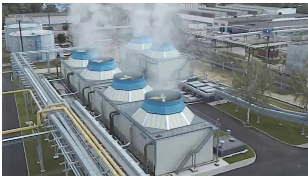
Рис. 17.23. Вентиляторная вытяжная градирня
