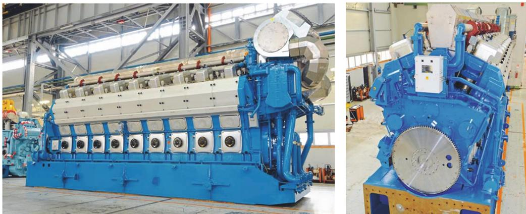
**Рис. 20.5. Газопоршневой двигатель Wärtsilä 18V50 SG**
