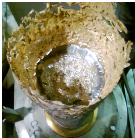
Рис. 4.74. Вакуумная дуговая печь фирмы «КОМТЕРМ» и выплавленный в ней композитный слиток диаметром 250 мм
