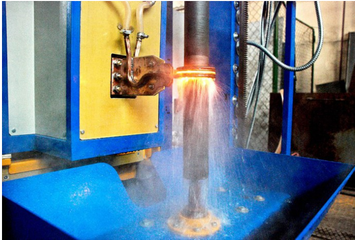
Рис. 3.72. Процесс непрерывно-последовательной индукционной поверхностной заковки
