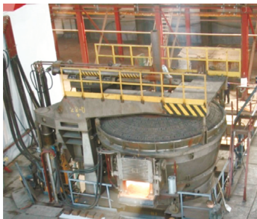
Рис. 4.54. Дуговая сталеплавильная печь постоянного тока вместимостью 12 т производства фирмы «КОМТЕРМ», г. Москва («ВКМ-Сталь», г. Саранск)
