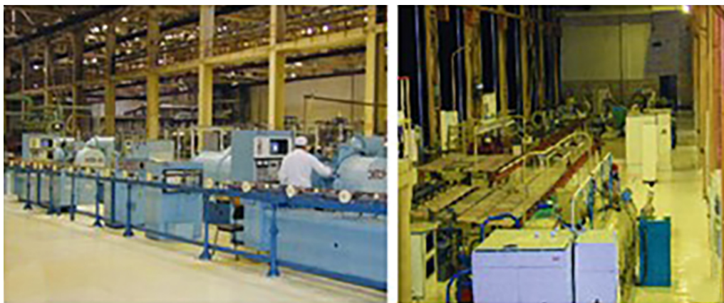
Рис. 6.21. Автоматическая линия сварки ТВЭЛов
