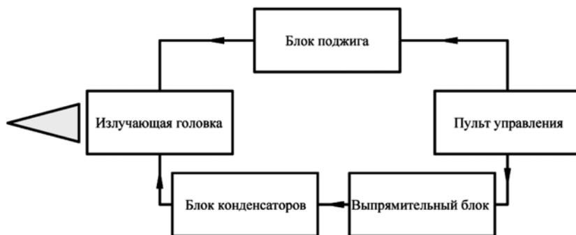
Рис. 7.6. Функциональная схема оптического генератора
