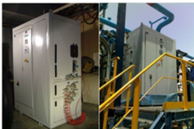
Рис. 5.25. Внешний вид плазменного модуля мобильной опытно-промышленной установки
