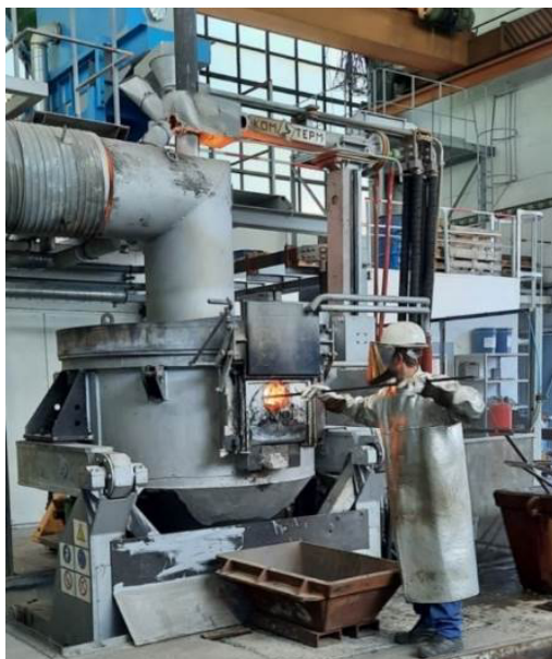
Рис. 4.65. Реализация процесса извлечения драгоценных металлов из отслуживших автокатализаторов в руднотермической печи ДП-0,5 производства фирмы «КОМТЕРМ»
