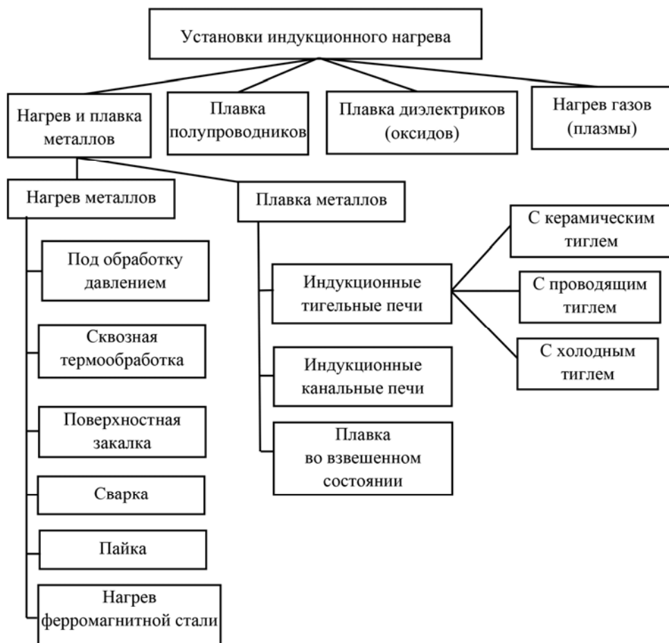
Рис. 3.1. Классификация устройств индукционного нагрева
