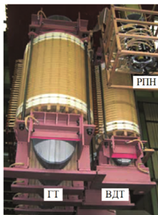
Рис. 4.94. Силовая схема и активная часть печного трансформатора мощностью 150 МВА печи вместимостью 180 т
