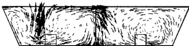
Рис. 4.42. Вектора скорости при несимметричном распределении токов двух подовых электродов
