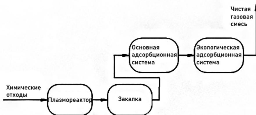
Рис. 5.24. Принципиальная схема мобильной опытно-промышленной плазменной установки
