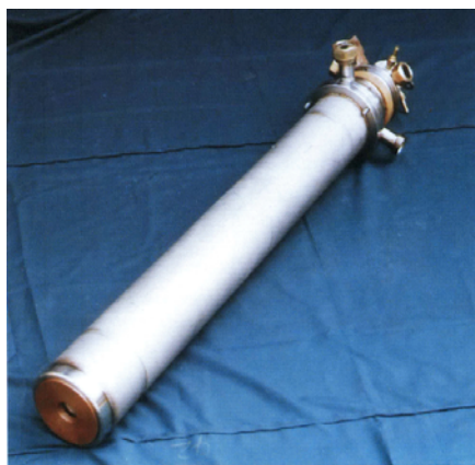
Рис. 5.9. Плавильный плазмотрон, работающий на аргоне при токах до 6000 А
