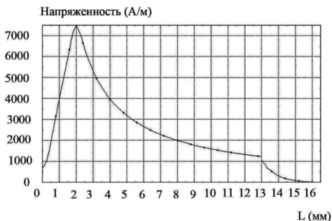
Рис. 3.117. Распределение плотности тока (а) и направленности магнитного поля по радиусу исследуемой системы (б)
