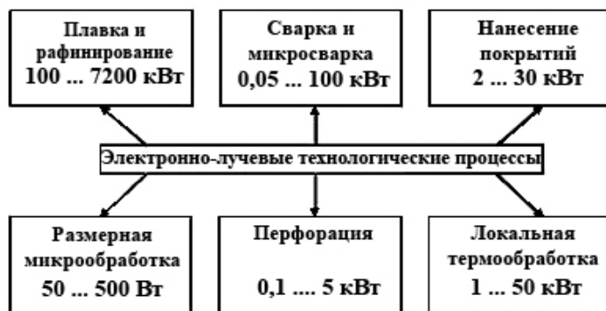
Рис. 6.3. Основные виды электронно-лучевых технологических процессов
