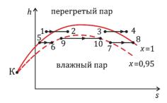
Рис. 9.24. Изменение влажности влажного пара при адиабатном дросселировании
