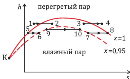
Рис. 9.24. Изменение влажности влажного пара при адиабатном дросселировании
