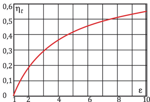
Рис. 14.3. Зависимость термического КПД \eta_t цикла ДВС с подводом теплоты при v = \text{const} от степени сжатия \varepsilon
