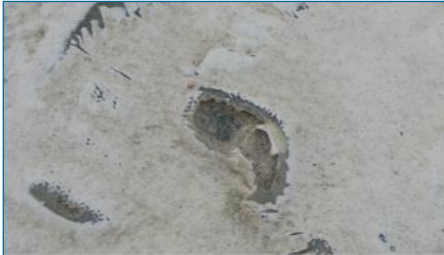
Рис.73. Повреждённая и острая поверхность лопасти в результате того, что посетители парка ходили и играли на ней (фото: Piero Medici, 2011)
