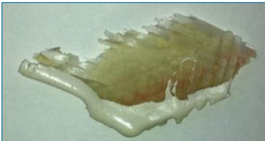
Рис.74. Образец острой отделки из стекловолокна, эпоксидной смолы и белой краски (фото: Piero Medici, 2011)
