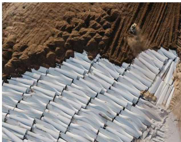
Рис. 70. Захоронение лопастей ВЭУ на свалке города Каспер (штат Вайоминг). Фото: Benjamin Rasmussen for Bloomberg Green. Источник: [77]
