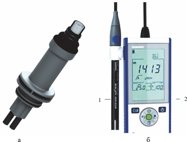
Рис. 5.12. Конструкция лабораторной ячейки для измерения электропроводности растворов электролитов (а) и кондуктометр (б):
