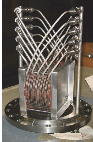
Рис. 5.22. Мембранный модуль установки получения особо чистого водорода из смеси газов
