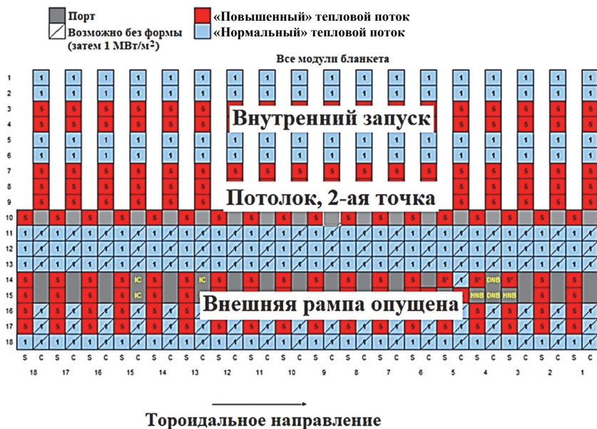
Рис. 5.16. Распределение «нормальных» (светло-серых) и «улучшенных» (темно-серых) панелей первой стенки
