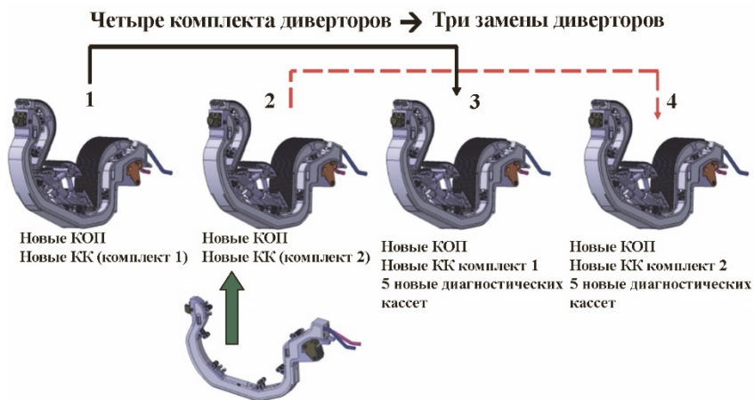
Рис. 5.23. Автономный ремонт дивертора:
