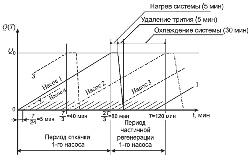
Рис. 6.2. Схема цикличности работы криогенных насосов:
