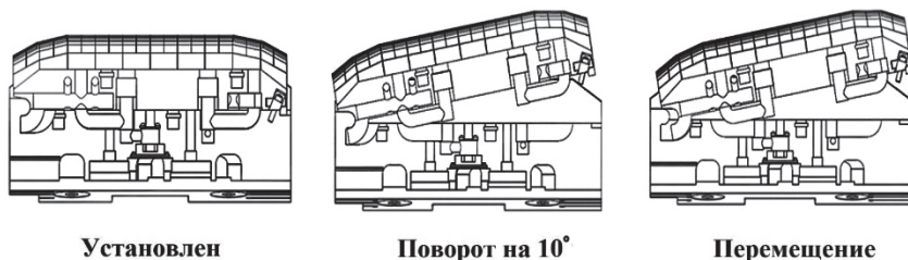
Рис. 5.17. Упрощенный процесс установки и снятия панели первой стенки
