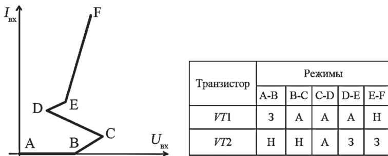
Рис. 10.22. Входная характеристика триггера Шмитта (а) и таблица состояний (б)
