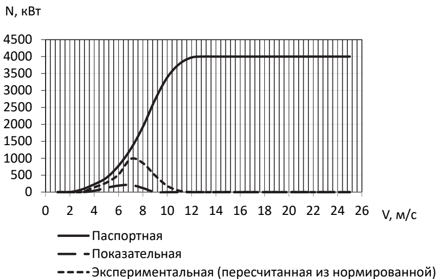
Рис. 10.38. Паспортная, экспериментальная и показательная мощностные характеристики для условий тяжелого обледенения
