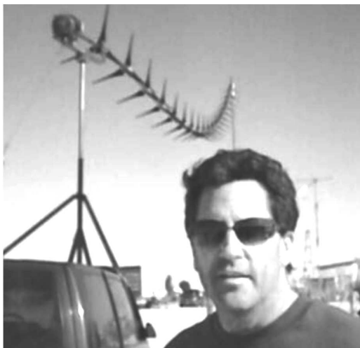
Рис. 2.18. Даг Селсам со своей ВЭУ Sky Serpent. ВЭУ имеет 26 РК диаметром 1 м и способна обеспечивать мощность в 1,1 кВт при скорости ветра 9 м/с
