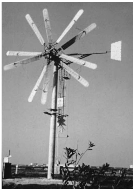
Рис. 2.15. ВЭУ NOAH мощностью 45 кВт, диаметр ВК – 10 м, высота башни – 12 м. Обратите внимание на кабели, соединяющие лопасти
