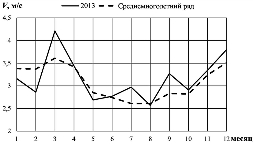
Рис. 6.13. Годовые вариации среднемесячной скорости ветра на высоте 10 м на площадке МС Черный Яр
