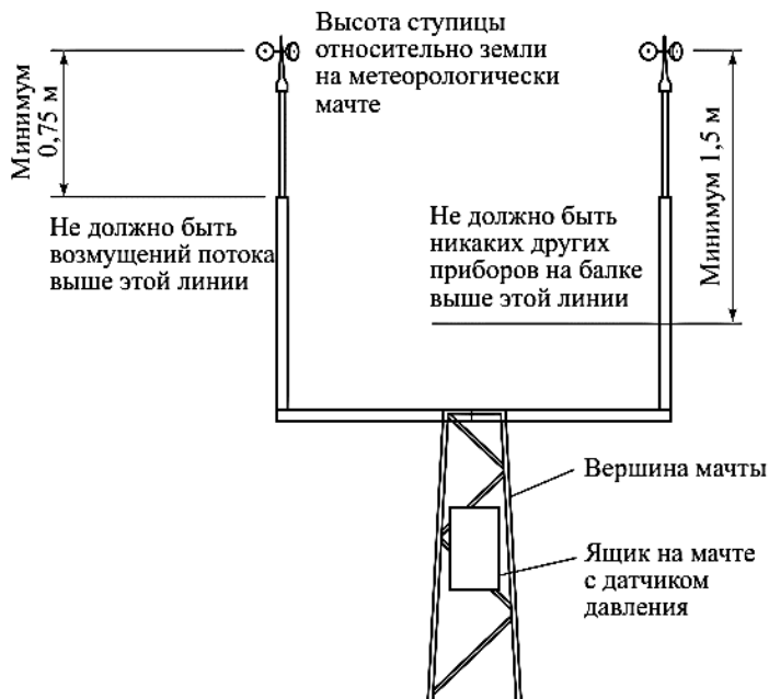
Рис. 7.13. Пример альтернативного крепления основного и контрольного анемометров в верхней части мачты, а также флюгера и других приборов на балке
