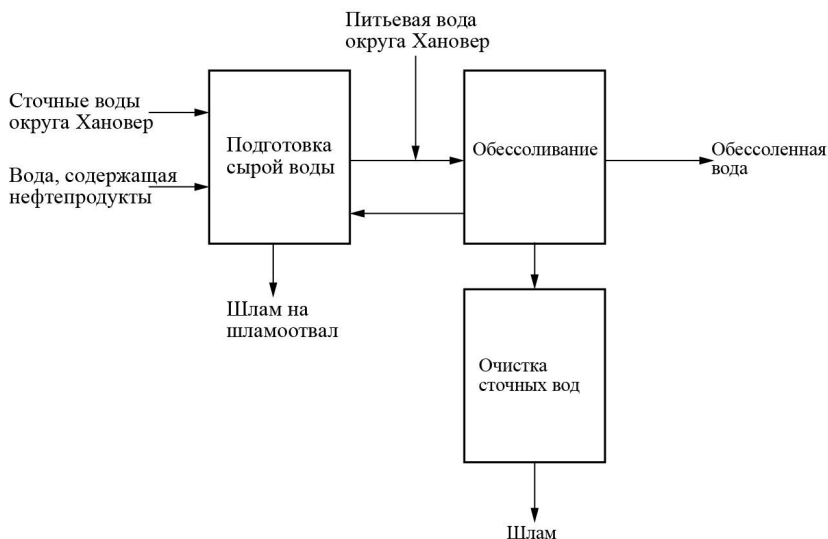
Рис. 9.5. Схема водообработки на ТЭС Досвелл
