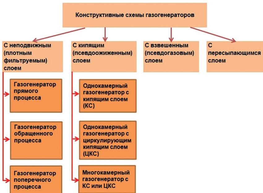
Рис. 3.19. Классификация газогенераторов
