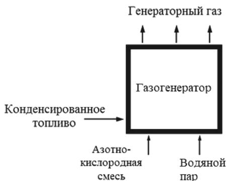
**Рис. 3.38. Расчетная схема газогенератора**
