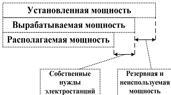
Рис. 2.6. Структура приходной части баланса активной мощности
