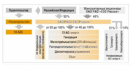
Рис. 3.1. Схема управления электроэнергетикой России до реформы ОАО «РАО ЕЭС России»
